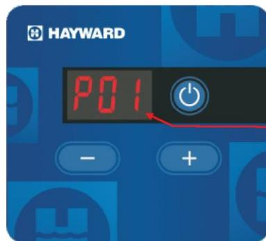
Défaillance du capteur de la température de l'eau d'entrée
